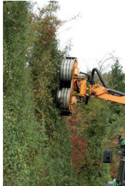
Der Schneidkopf (Skorpion) wird an einen Traktor angebaut und kann drei Arbeitsgänge gleichzeitig erledigen: Schnitt, Häckseln, Räumen.
